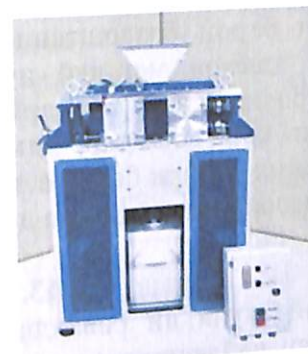
Расми 28. Намуди умумии сангмайдакунаки дунаварда Дар сангмайдакунакҳои болғагӣ (расми 29), мавод дар фазои корӣ пора карда мешавад. Маҷмӯи дискҳо дар навард, вале дар меҳвар болғаҳо насб карда шудаанд. Ҳангоми гардиши навард мавод ба майдони корӣ ворид мешавад ва бо болғаҳо зада шуда ба танаи сангмайдакунак пош хӯрда пора-пора мешаванд. Ҳангоми зарба хӯрдан порчаҳои мавод иловатан пора мешаванд.
