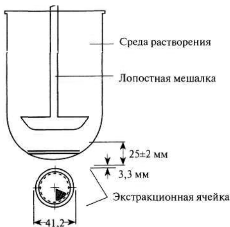
Рис. 21. Прибор «Лопасть над диском» (Е. И. Климова)
