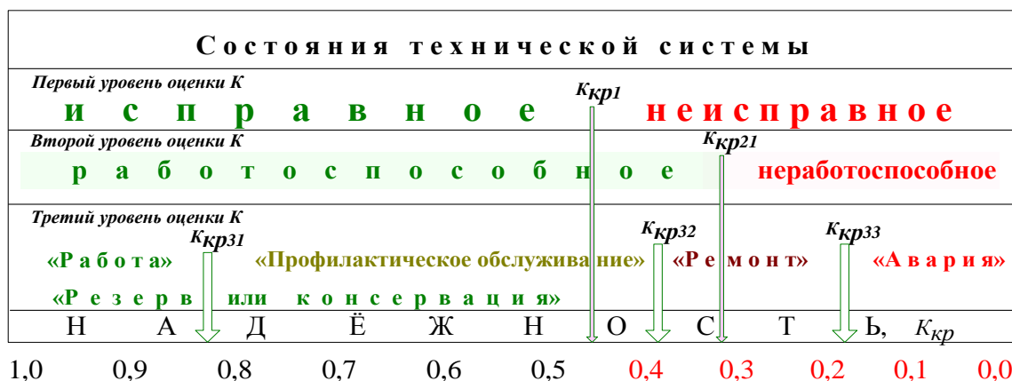
Рис. 1.1. Графическая модель технического состояния объекта магистрального трубопровода
