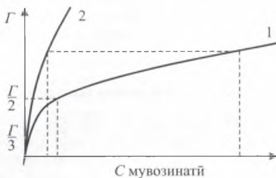
Расми IX.6. Алоқамандии миқдори ионҳои адсорбсияшуда дар тақсон аз консентратсия мувозинати ионҳои дар маҳлул нишон дода шудааст: 1 – изотермаи адсорбсионӣ барои ионҳои ғайриорганикӣ; 2 – барои ионҳои яқвалентаи органикӣ, рангҳо ва алколоидҳо
