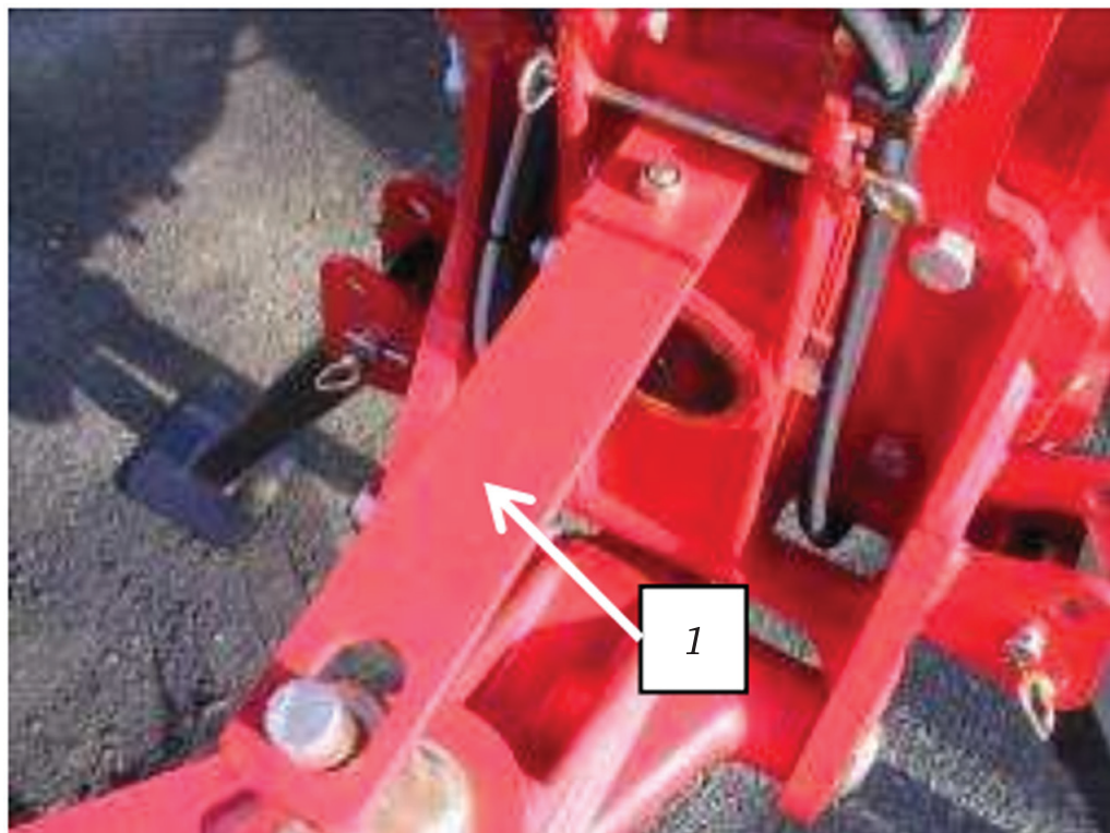
Рис. 1.18. Защелка траверсы: 1 — защелка
