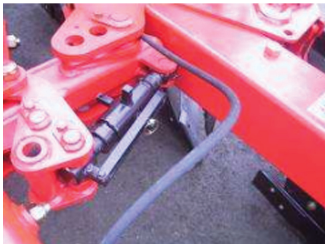
Рис. 1.21. Механизм поворота опорного колеса
