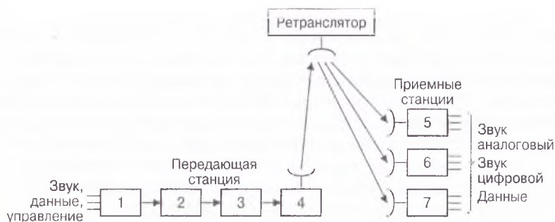
Рис. 2.8. Структурная схема спутниковой системы цифрового радиовещания:
