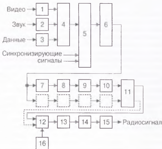
Рис. 1.1. Преобразование данных и телевизионных сигналов в передатчике DVB-T
