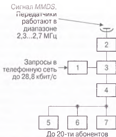
Рис. 3.15. Структурная схема спутниковой системы высокоскоростного доступа в Интернет
