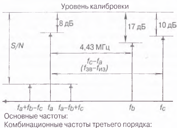
Рис. 4.4. Уровни входных сигналов при изменении канальной интермодуляции
