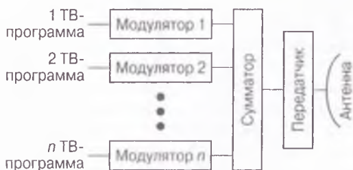
Рис. 1.7. Структурная схема системы MMDS при многоканальном передатчике
