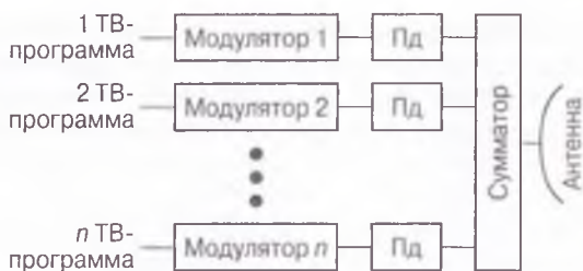
Рис. 1.6. Структурная схема системы MMDS при одноканальном передатчике
