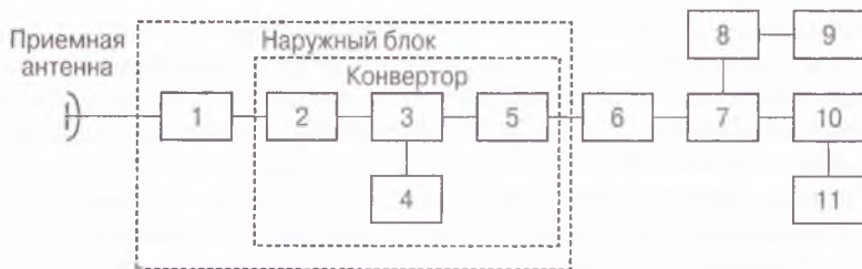
Рис. 3.2. Структурная схема приемной индивидуальной установки спутниковой цифровой системы ТВ:
