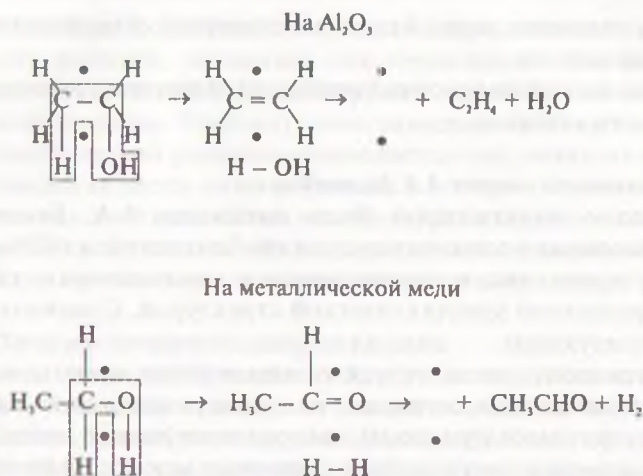
Рис. 24.4. Схема образования и распада дублетных комплексов. Черными кружками обозначены атомы дублета катализатора. Индексные группы атомов обозначены пунктирным контуром.
