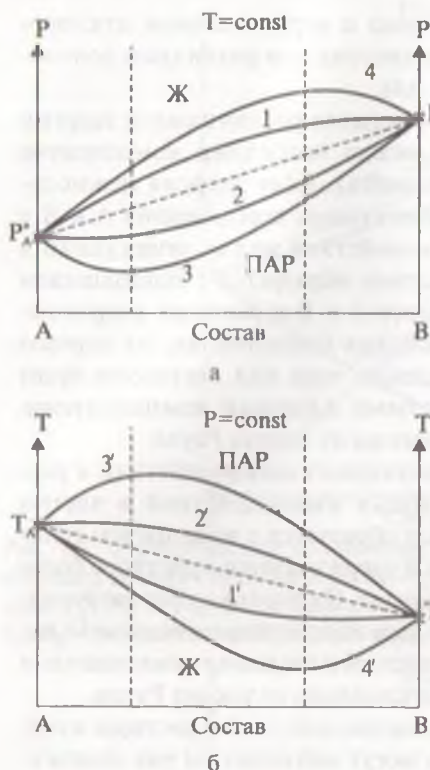
Рис. 9.5. Диаграмма зависимости давления насыщенного пара от состава жидкой фазы (а) и диаграмма кипения (б) для бинарной смеси летучих веществ А и В.
