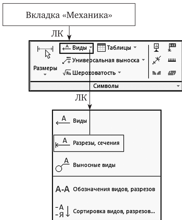
Рис. 5.32. Общая схема выбора команды Разрезы и сечения
