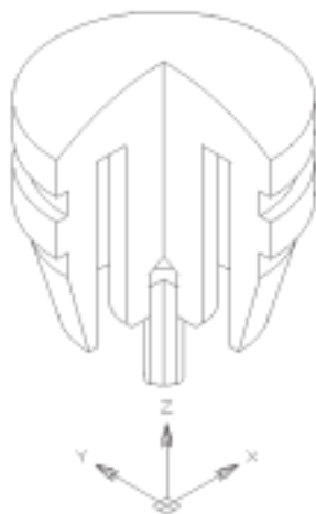
Рис. 6.35. Построение выреза в ЮЗ изометрии 3D-модели сборочной единицы, этап 3
