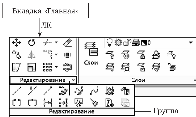
Рис. 1.13. Пример разворачивания группы Редактирование на вкладке «Главная»
