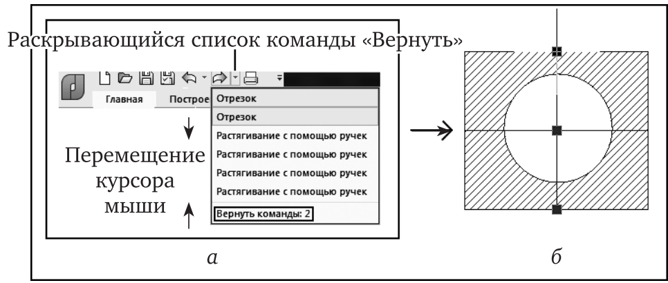
Рис. 1.20. Пример наглядных действий при активации команды Вернуть : а — выбор объектов чертежа из раскрывающегося списка для возврата действий; б — результат возврата действий двух команд на чертеже
