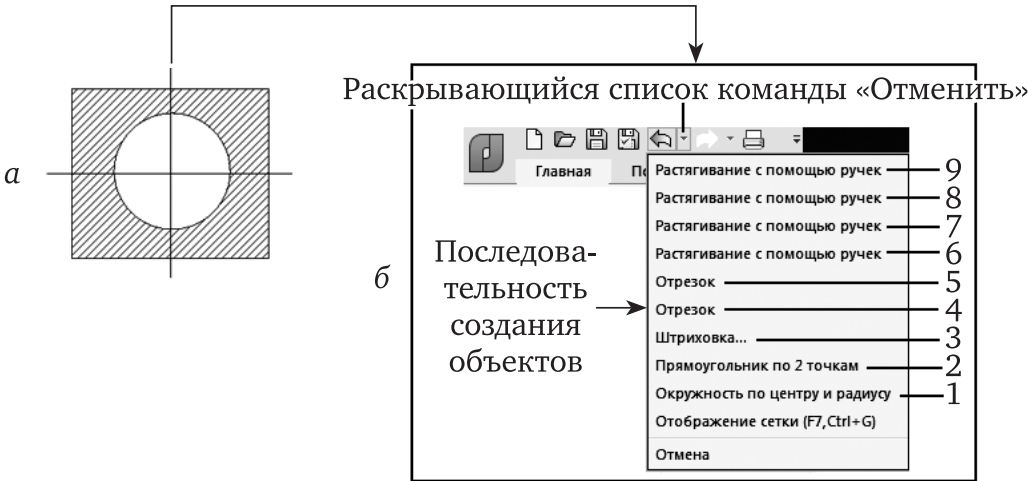
Рис. 1.17. Схема активации команды Отменить на Панели быстрого доступа: а — исходный чертеж; б — раскрывающийся список с объектами чертежа для отмены действий
