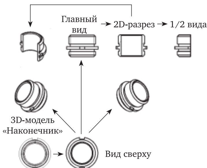
Рис. 4.11. Пример построения 2D-видов, 2D-разреза, 1/2 вида и аксонометрических проекций 3D-модели детали «Наконечник»
