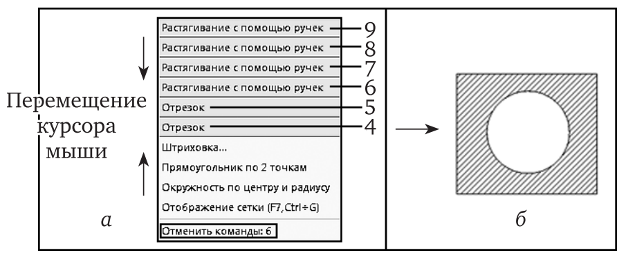
Рис. 1.18. Пример наглядных действий при активации команды Отменить : а — выбор объектов чертежа из раскрывающегося списка для отмены действий; б — результат отмены действий шести команд на чертеже
